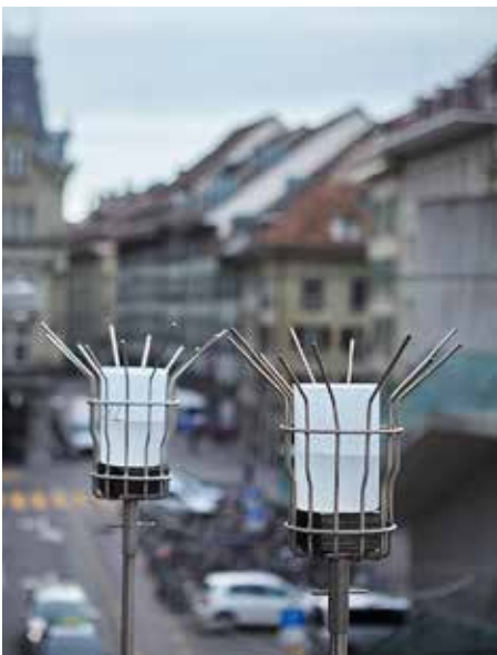
Mit diesen sogenannten Bergerhofftöpfen werden der Staubniederschlag und die Deposition von Schwermetallen bestimmt. Das Metallgitter dient als Halterung und Vogelschutz.
