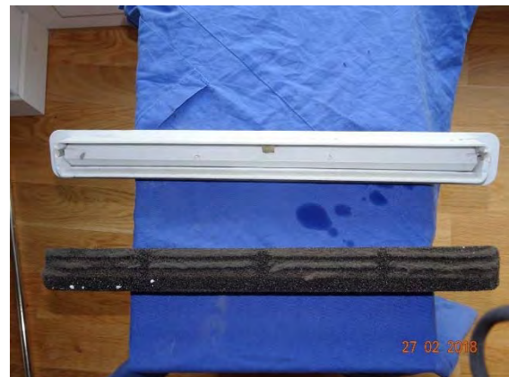
Abbildung 155: WNG ID 720: Zuluftfilter
