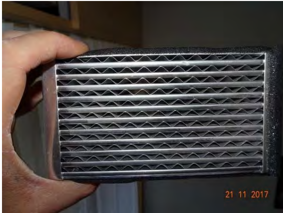
Abbildung 34: WNG ID 120: Wärmetauscher
