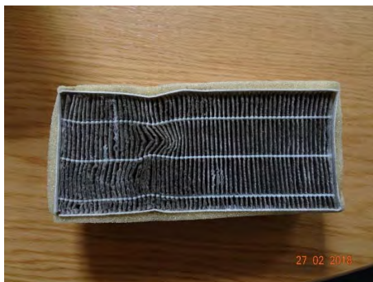
Abbildung 220: WNG ID 1010: Zuluftfilter
