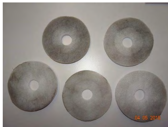
Abbildung 207: WNG ID 910: Zuluftfilter, Rückseite
