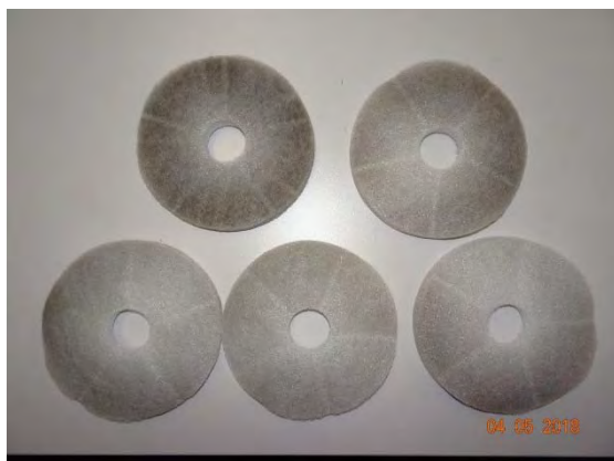
Abbildung 206: WNG ID 910: Zuluftfilter
