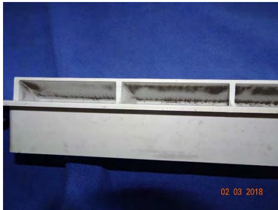
Abbildung 176: WNG ID 730: Ablagerung an ZUL-El.
