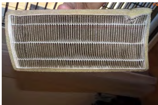
Abbildung 125: WNG ID 610: Zuluftfilter
