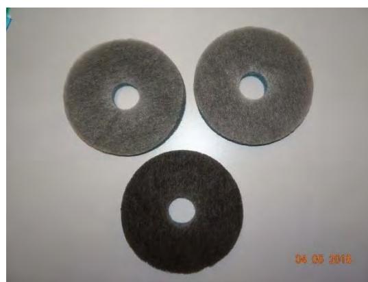
Abbildung 212: WNG ID 920: Zuluftfilter, Rückseite
