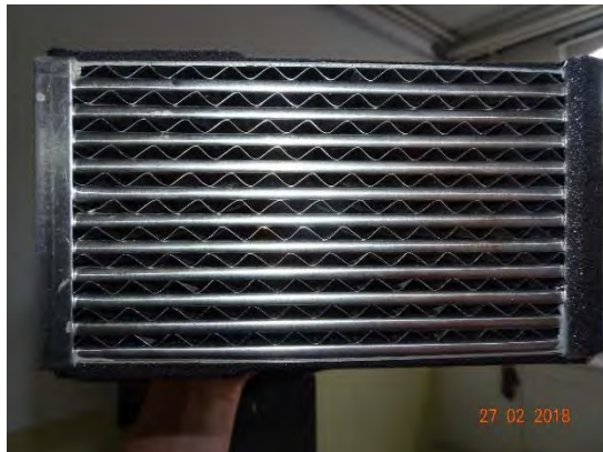
Abbildung 224: WNG ID 1010: Wärmetauscher
