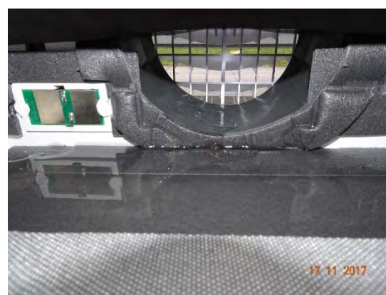
Abbildung 46: WNG ID 210: Kondensat in Gerät
