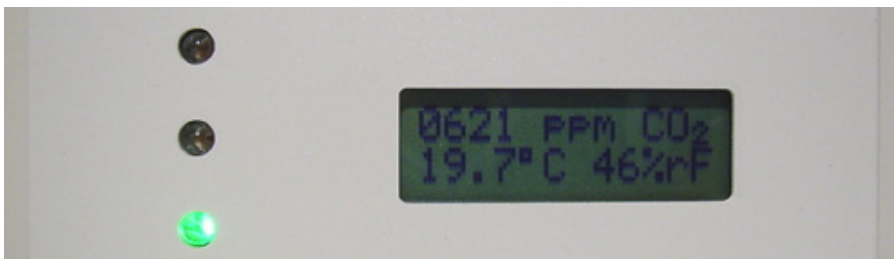
Abbildung 1: Luftampel (Quelle: www.raumlufthygiene.ch )
