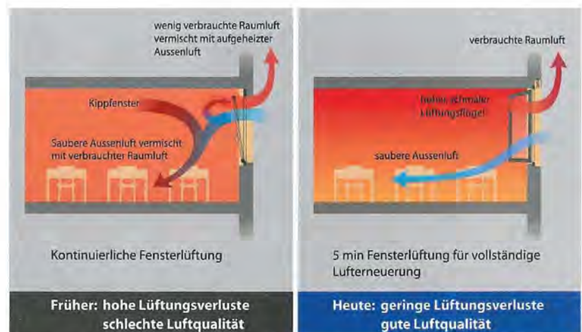
Effizienz einer natürlichen Stosslüftung: heute optimiert mit hohen, schmalen Lüftungsfügel. (Referat Philipp Deflorin)
