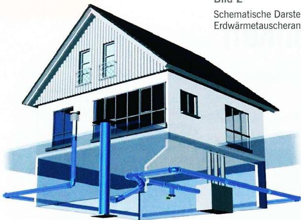
de Effekte durch die Vorerwärmung der Luft im Winter sowie die Frostfreihaltung von Wärmerückgewinnungskomponenten.
