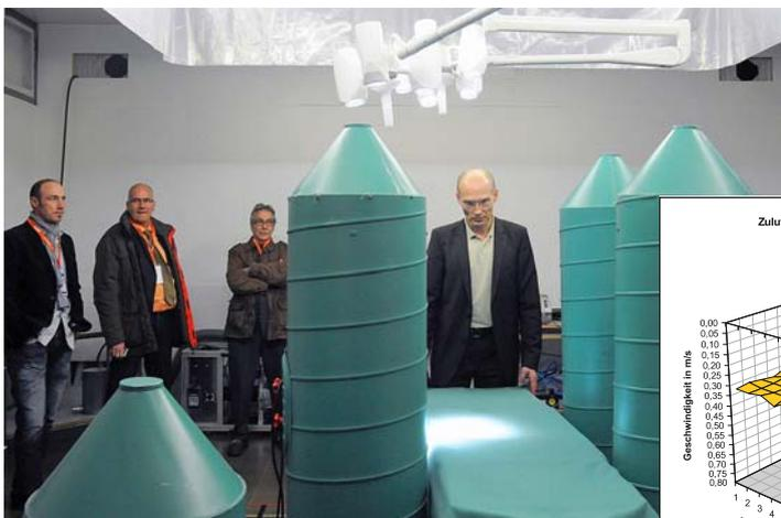
Rüdiger Kämpmann (rechts) zeigt Tagungsteilnehmern im Labor-OP der HSLU die zylinderförmigen Dummies, die auf dem 3x3 m grossen Operationsfeld beispielsweise das OP-Team und den Instrumententisch darstellen und realitätsnahe Vergleichsmessungen erlauben.
